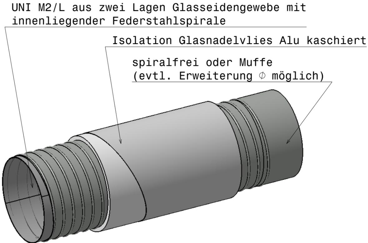
Innendurchmesser: von  $\phi 19\text{mm}$  bis  $\phi 305\text{mm}$ , Zwischenabmessungen auf Anfrage
